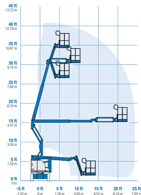
\* Altura de trabajo = Altura de la plataforma + 2 m
